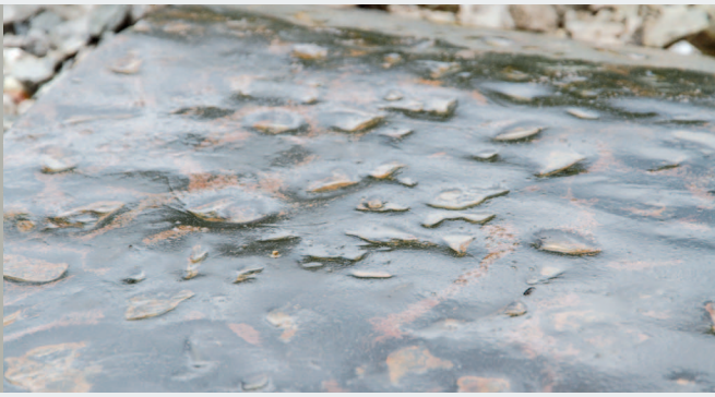
Abdrücke der Schottersteine auf den Unterschottermatten
